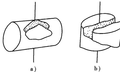
图 T0225-4 不正确试验的破坏模式
